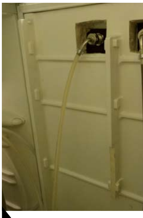
Wyprowadzenie przewodów z piwem na zewnątrz kegeratora.
